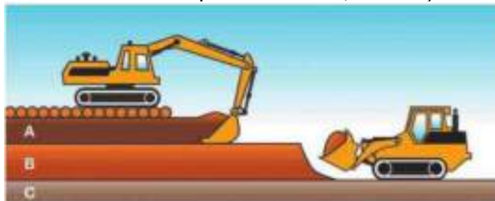
Figure 5.31 : Décapage du sol sans rouler sur l'horizon. Extrait de la norme SN 640 581
