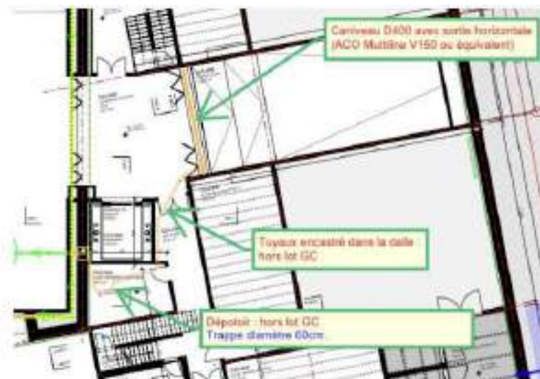
Figure 5.15 : Raccordement du caniveau au réseau EC
