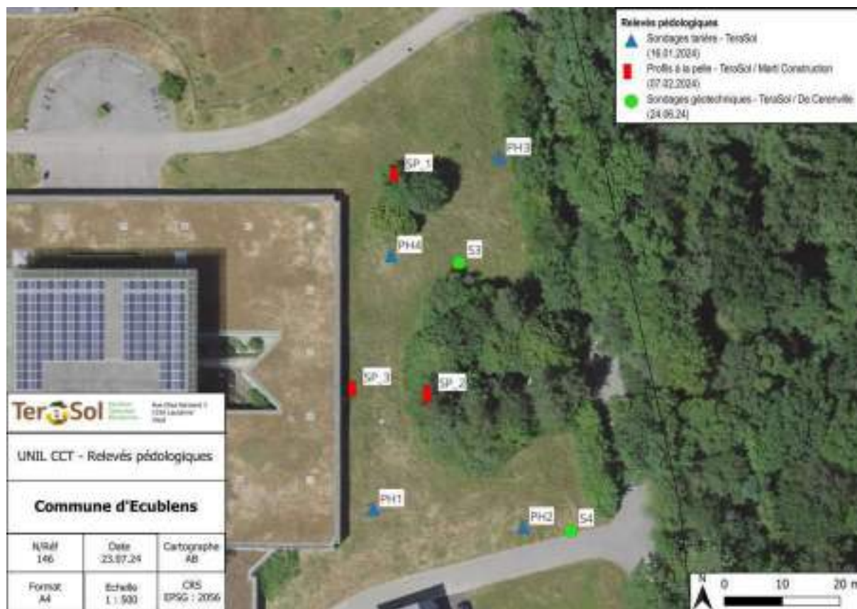
Figure 5.22 : Carte de synthèse de l’ensemble des sondages et fosses pédologiques réalisés
