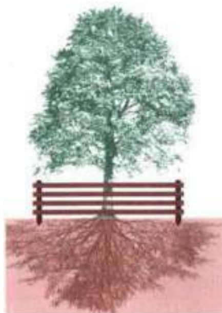
Figure 5.45 : Schéma de la protection optimale d'un arbre (diamètre couronne + 1m).
